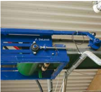
DeLaval BF500-matoruokkijan vetoyksikkö
