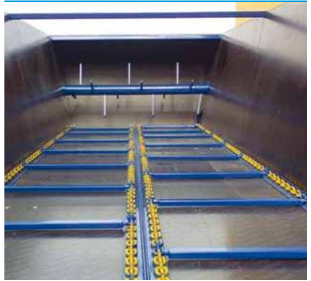
Limittäin olevat täyttöpöydän kolat takaavat tasaisen syötön
