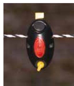
Bilde 16. Voltalarm gir raskt signal om det er for liten spenning i tråden.
