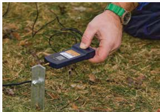
Bilde 26. Mål spenningen med DeLaval digitale voltmeter så får du klar beskjed om allt er OK.
