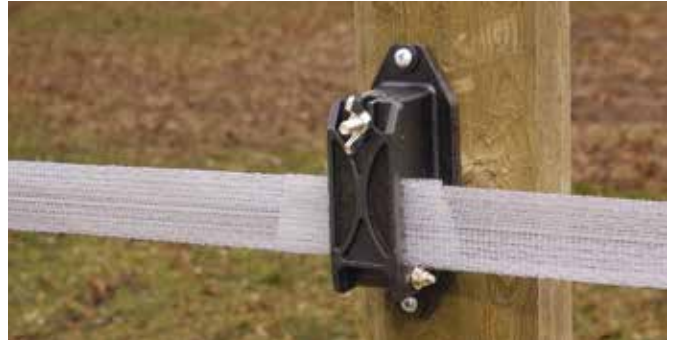
Bilde 8. Skjøt bandet med en hjørne-/lendeisolator, samt skjøteplate. Gir sikker skjøt og kontakt mellom band.
