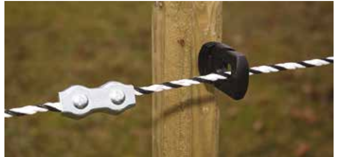
Bilde 8. Bruk kaus og trådsjøt med vingemutter når du skjøter. Gir sikker kontakt mellom trådene.
