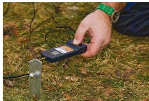
Bilde 26. Mål spenningen med DeLaval digitale voltmeter, så får du klar beskjed om alt er OK.
