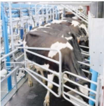
Robuuste in- en uitloophekken en keerbuizen bevorderen de koe-positionering en versnellen het koe-verkeer.
