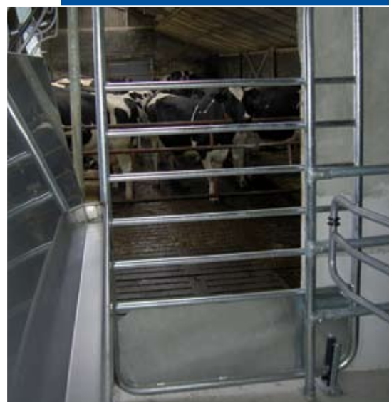
Het inloophek is een zwaar uitgevoerd schuifhek. Dit schuifhek zorgt voor een compacte inbouwmaat van de melkstal en van het herkenningsportaal.
